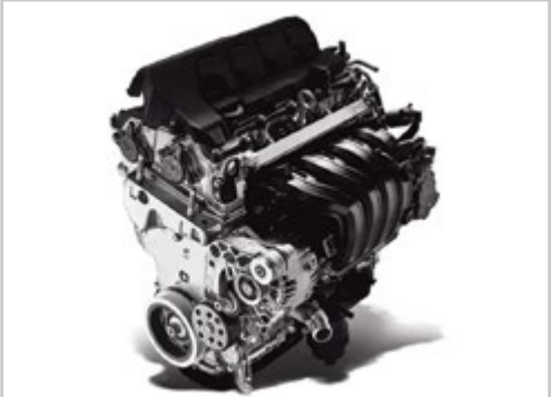
Động cơ xăng SmartStream G1.5 sản sinh công suất cực đại 115 mã lực tại 6300 vòng/phút và đạt momen xoắn cực đại 144Nm tại 4500 vòng/phút
